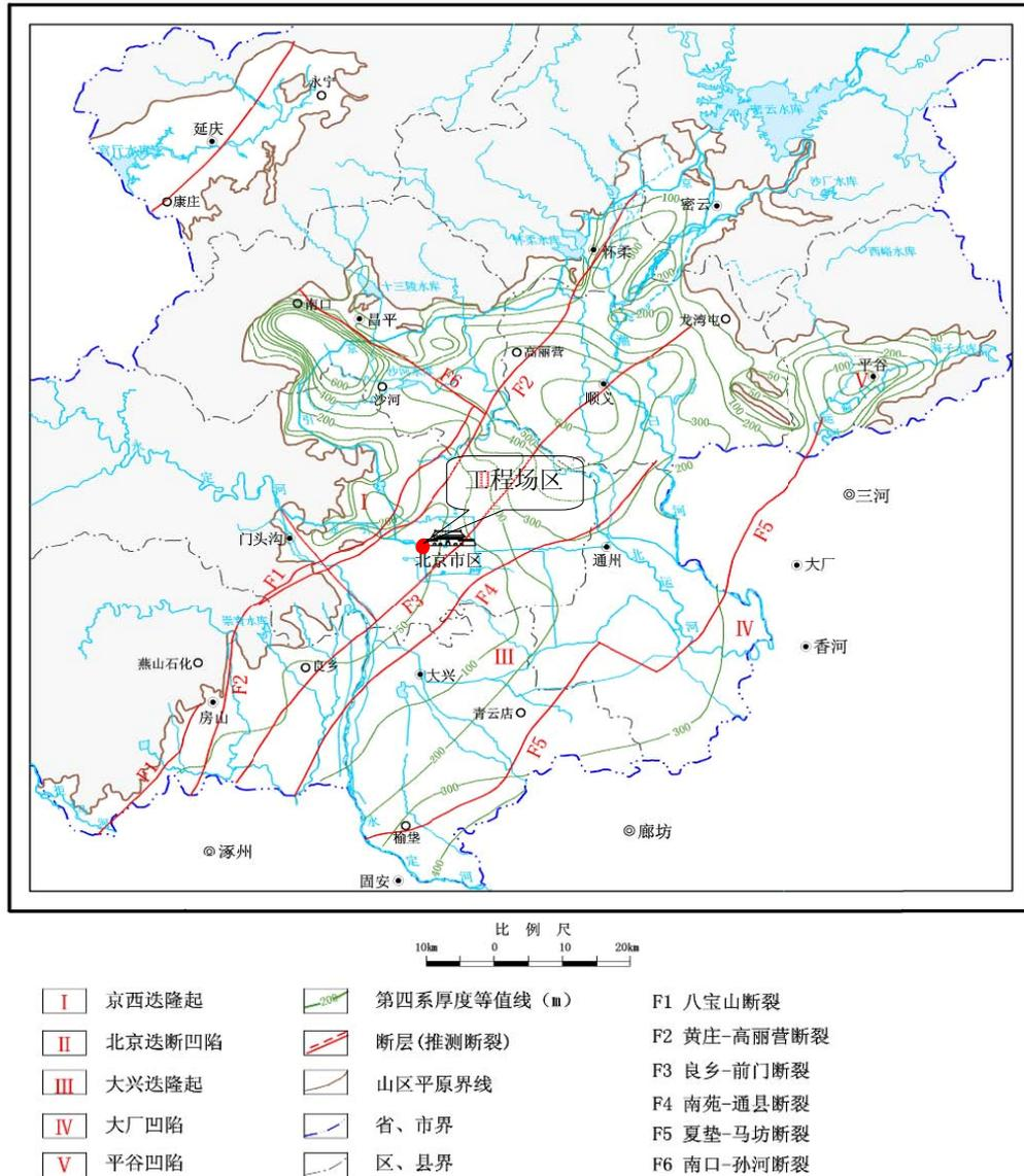
图 4-3 北京市平原区基底构造图
